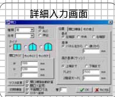
開口マスタで設定した符号を選択するか、符号入力します。(サイズと補強材は、マスタ設定されていれば自動入力されます) 基点と基準と高さ基準を入力します。
