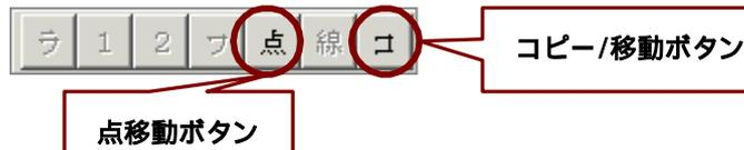
点移動ボタン・・・コーナーの端点の1点を指示し、その点の移動先の位置を指示します
